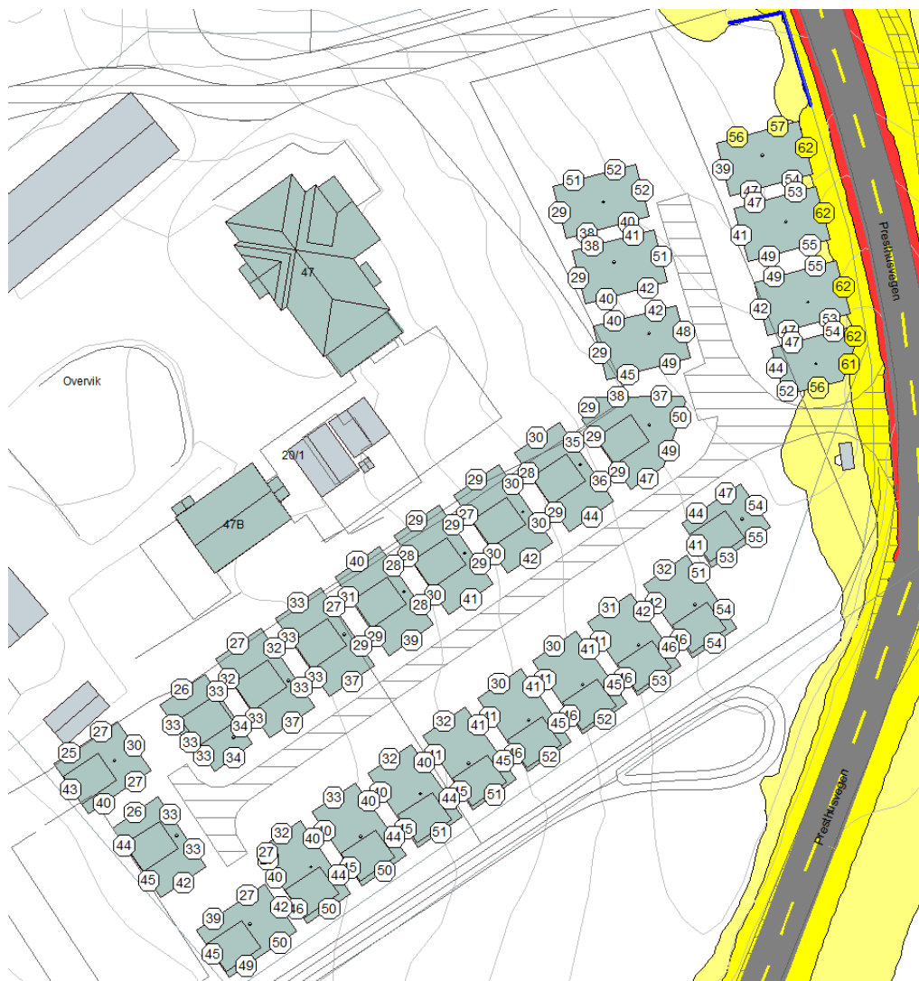
Figur 7 - Beregnet støynivå ( L_{den} ) på uteoppholdsareal og ved fasader, med 1,5 m høy og 22 m lang støyskerm, vist i blått. Beregningshøyde 1,5 m.
