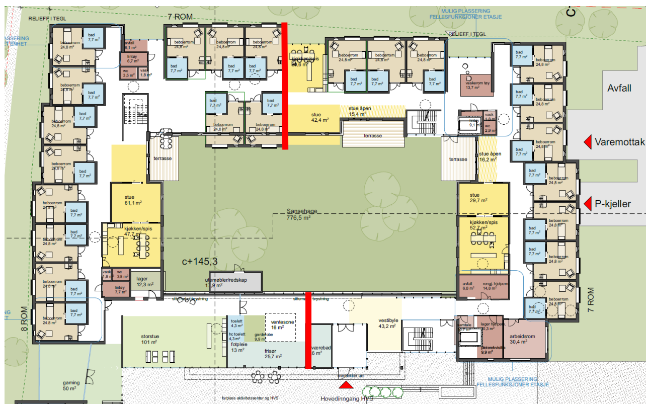
Figur 3: Utsnitt av oversiktsplan 1. etg. Mulig plassering av brannseksjoneringsvegg vist med røde linjer.
