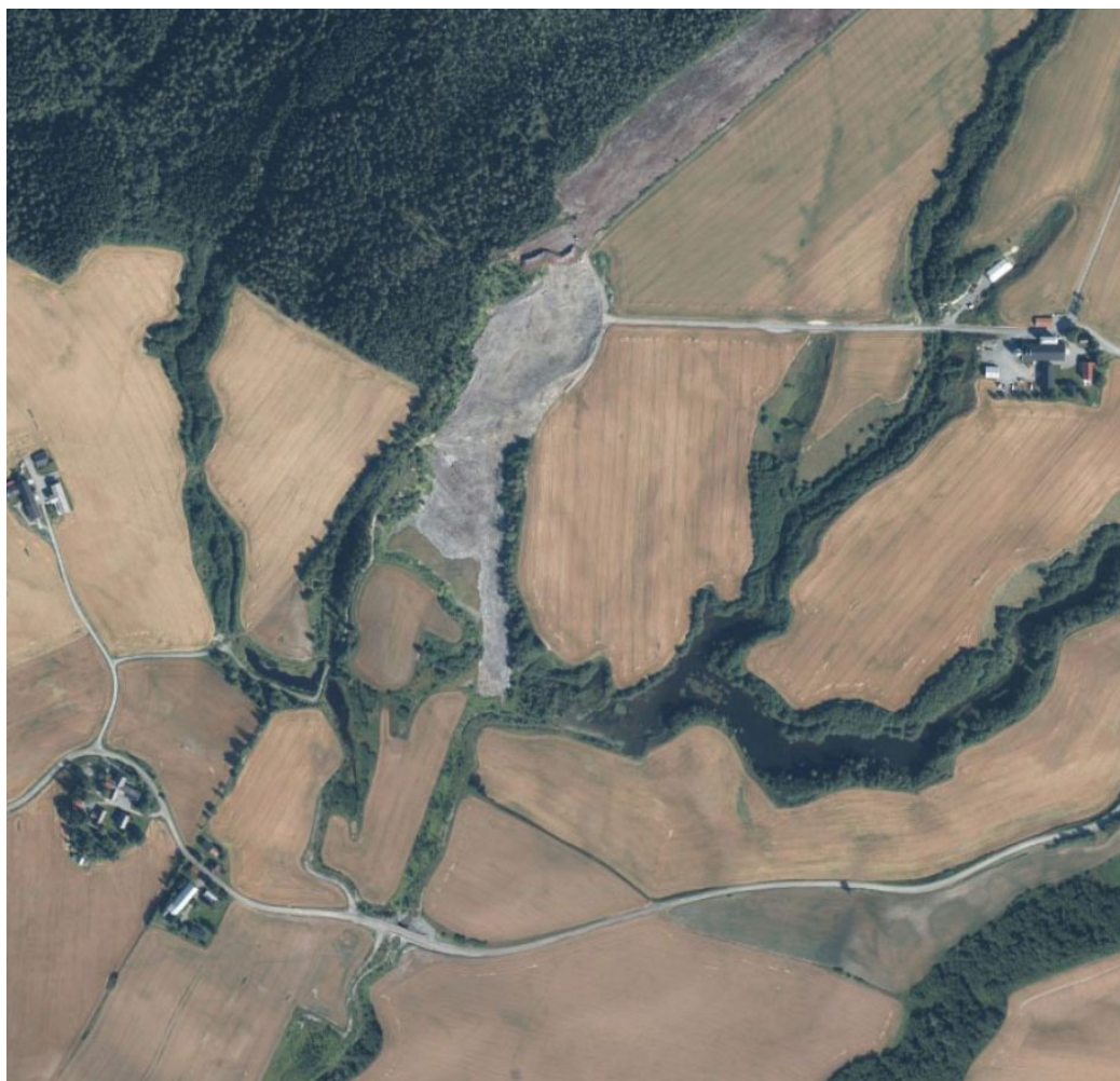
Figur 7.54. Avrenning av slam og finpartikler fra et massedeponi utgjør en stor vannøkologisk trussel for Ristbekken og vassdragets ørretbestand. Flyfoto fra 2022.
