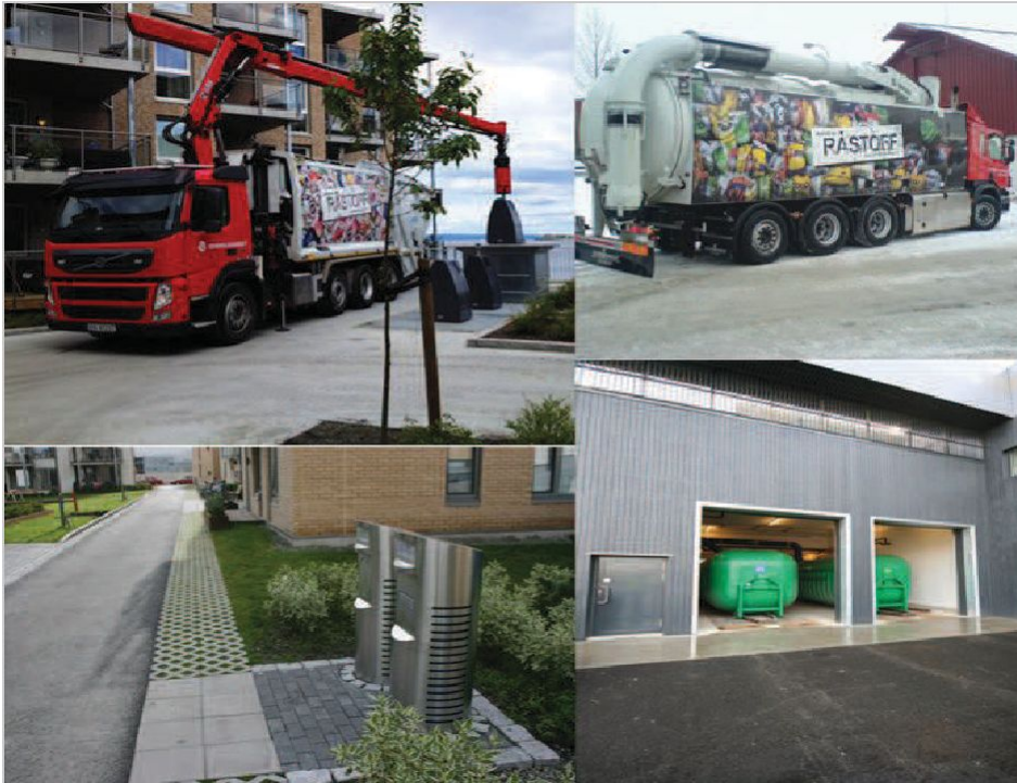
Figur 5: Eksempler på utstyr og installasjoner i forbindelse med nedgravde oppsamlingsløsninger. På bildet øverst til venstre er det kranbil som tømmer nedgravde containere. På bildet øverst til høyre vises bil for tømming av mobile avfallssuganlegg. På de to nederste bildene ser man nedkastpunkt og stasjon med containere i et stasjonært avfallssuganlegg. Foto: TRV/Trondheim kommune.
