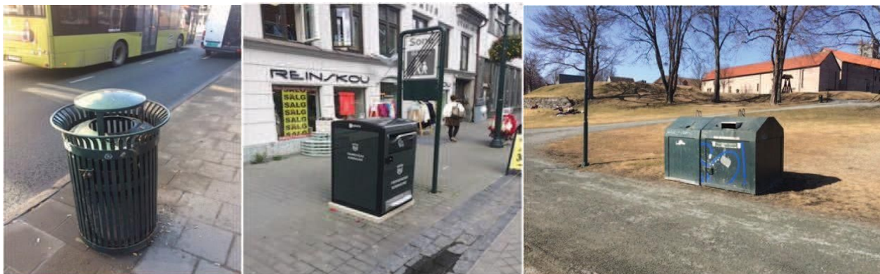
Figur 17: eksempler på oppsamlingsenheter og utstyr benyttet i forbindelse med avfall i det offentlige rom. Til venstre vises en vanlig avfallsbeholder som brukes i gater i sentrum. I midten vises en Bigbelly, se tekst. Til høyre vises containere som brukes i utfartsområder med stort publikumsbesøk. Foto: Trondheim kommune.
