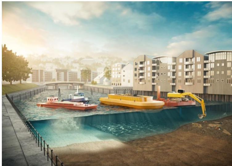
Figur 8: Grafisk fremstilling av skrotrydding, mudring med bakgraver og tildekking med fallbunnslekter. Illustrasjon: Paranode/Tibe T
