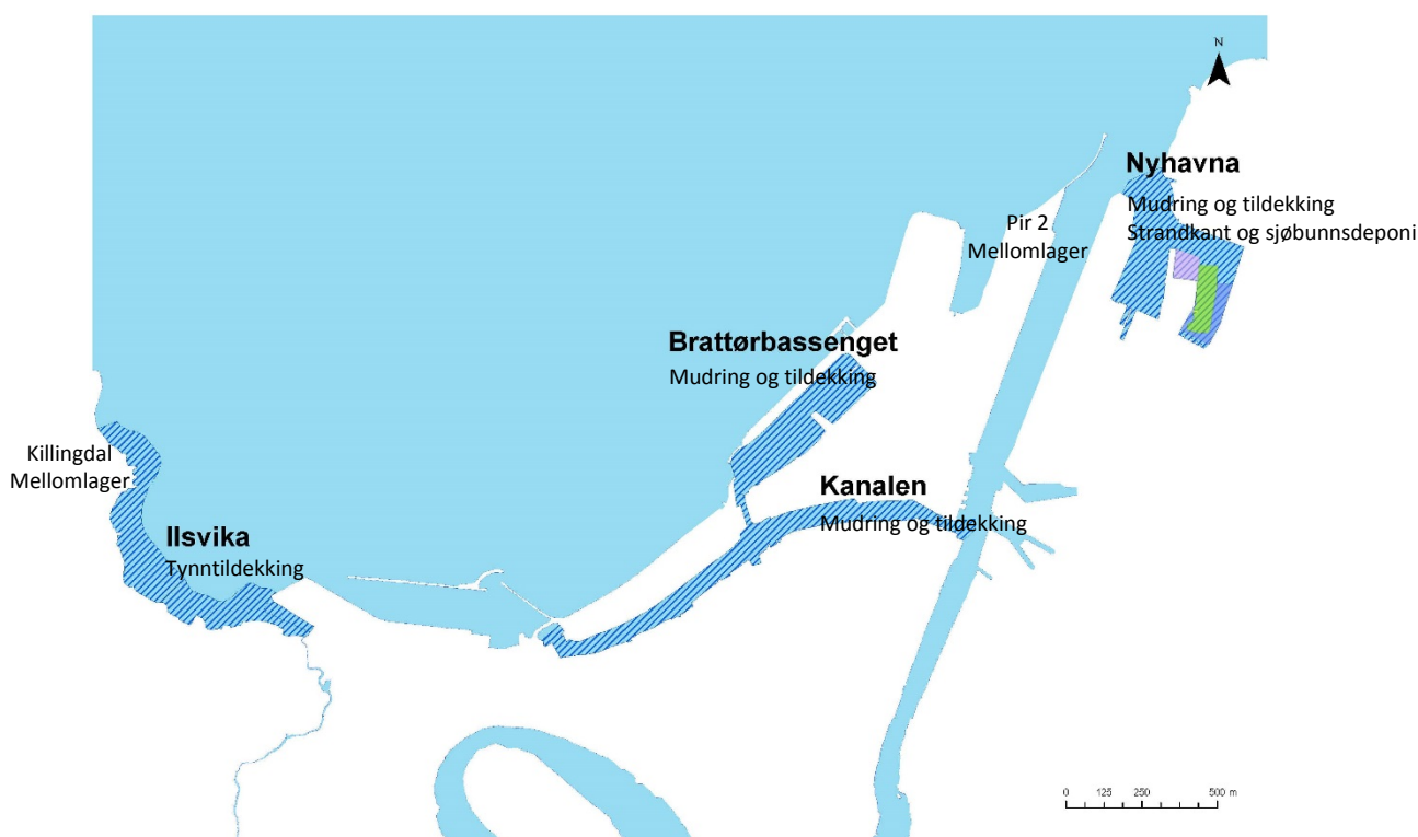
Figur 1 Tiltaksområder i Trondheim havn vist med blå skravur; Ilsvika, Kanalen, Brattørbassenget og Nyhavna. I Nyhavna er strandkantdeponi vist med lilla farge. Sjøbunnsdeponier er vist med hhv grønn og mørk blå farge. Mellomlager for tildekkingsmasser på Pir 2 og Killingdal-kaia er vist.
