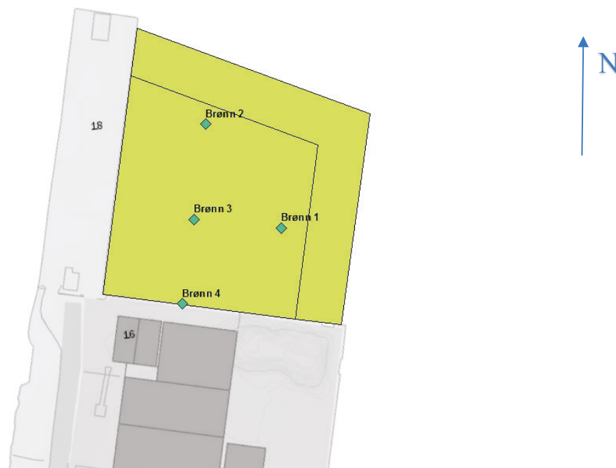
Figur 2 Grunnvannsbrønner etablert i strandkantdeponi i Nyhavna. Figuren viser øvre kant og skråning ned til bunn av sjetéer i nord og øst.
