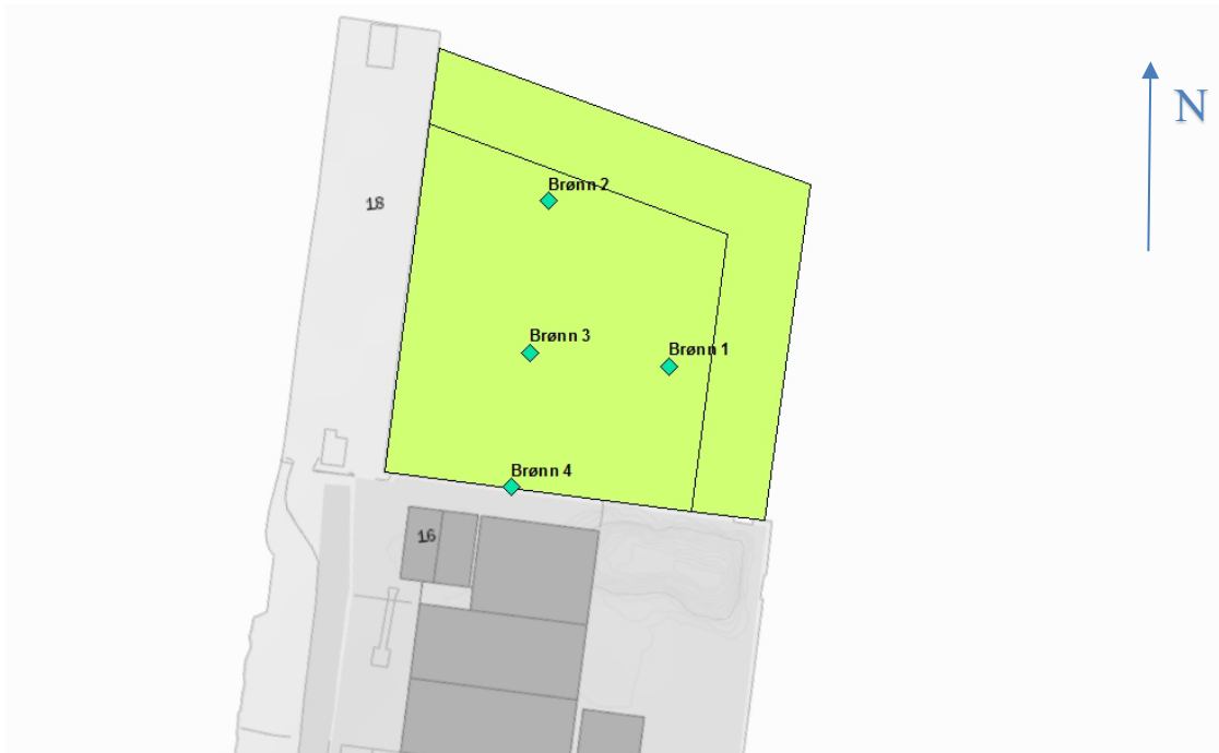
Figur 3 Grunnvannsbrønner etablert i strandkantdeponi i Nyhavna. Figuren viser øvre kant og skråning ned til bunn av sjetéer i nord og øst.
