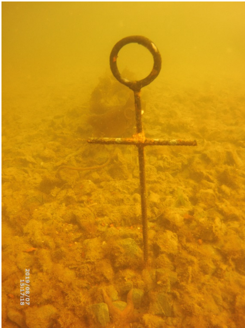
Figur 17 Målepinne etter den nye tildekkingen i indre basseng
