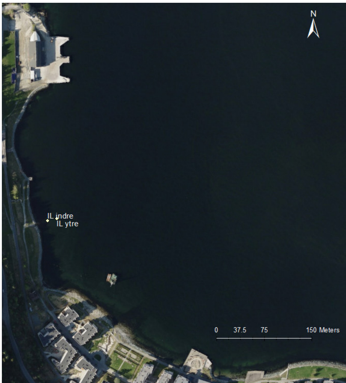
Figur 5 Målestasjoner for passive prøvetakere i Illsvika. Plassert i transekt fra utløp fra Killingdal. En stasjon umiddelbart utenfor et utløp fra Killingdal og én stasjon lengre ut. DGT-er er satt ut i to nivå i hvert av prøvepunktene.
