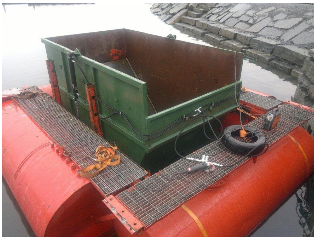
Figur 3: Fallbunnslekter med hydraulisk styreenhet (Foto: Agder Marine AS).
