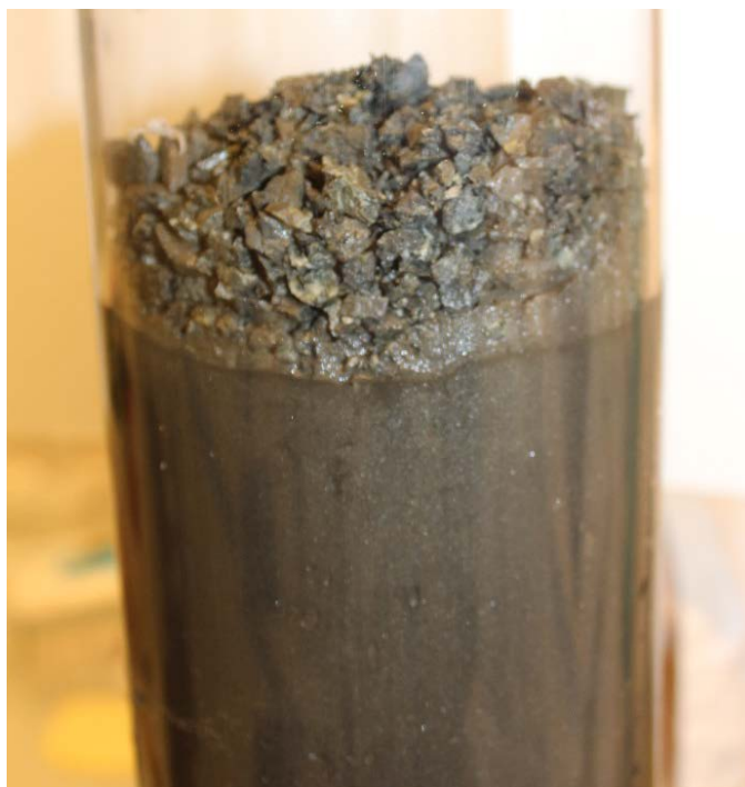
Figur 13: Kjerneprøve stasjon 30 fra prøvetaking september 2013. Bildet er tatt etter at vannet er dekantert fra.
