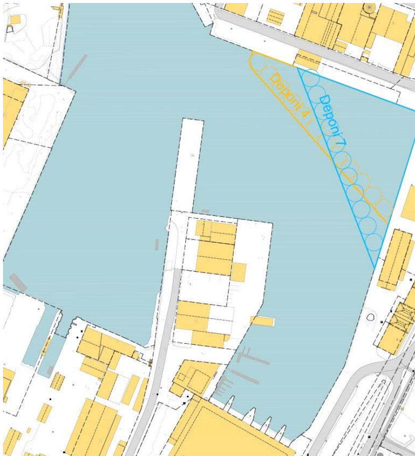
Figur 12 Foreslått utforming av deponi 4 og 7. Deponi 4 har et fyllingsvolum på 108 500 m 3 , mens deponi 7 har et fyllingsvolum på 99 000 m 3 .
