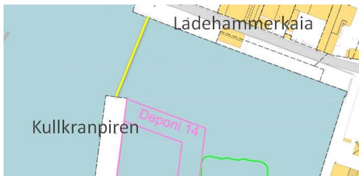
Figur 17 Forutsatt plassering av partikkelsperre, vist med gul linje.
