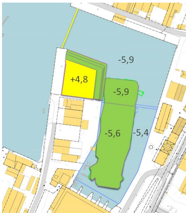
Figur 14 Høyder og dybder i østre basseng på Nyhavna, etter ferdigstilt tiltak. Høydereferanse LAT (laveste astronomiske tidevann, dvs. "sjøkartnull").
