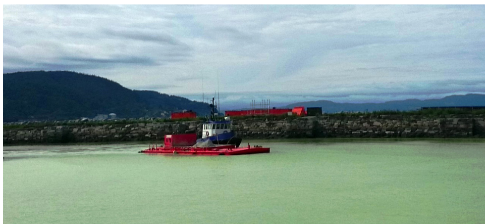
Figur 8 Tildekking med fallbunnslekter i Brattørbassenget.
