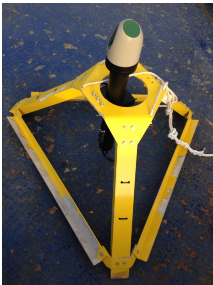
Figur 3.4 Strømmåler utplassert i Nyhavna (Aquadopp fra Nortek)
