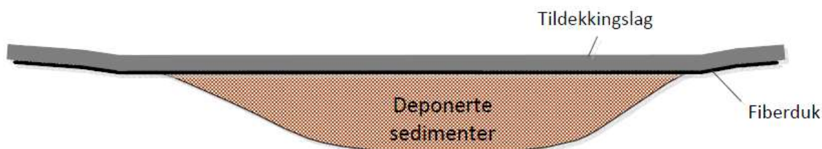
Figur 9 Prinsipp for sjøbunnsdeponi i grop (deponi 5).
