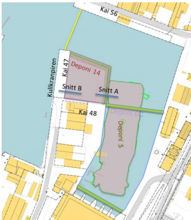
Figur 3 Planlagt deponiløsning i Nyhavna. Et strandkantdeponi ved Kullkranpiren (deponi 14), samt oppfylling av grop foran Dora I (deponi 5). Deponi 6C innebærer heving av sjøbunnen i østre basseng, mellom de grønne strekene i figuren, men antas ikke å komme til utførelse. Forutsatt partikkelsperre i tiltaksfasen er vist med gul strek i innløpet til østre basseng. Snitt A er vist i Figur 7, mens snitt B er vist i Figur 8.
