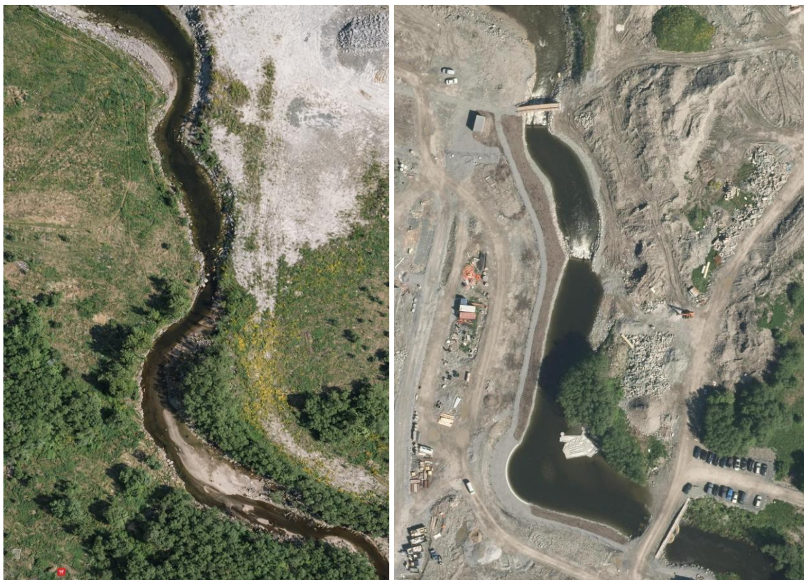
Figur 60. Nedre del av Vikelva før (t.v.) og etter (t.h.) konstruksjon av vandringshindrende terskler etter 2012. Flyfoto fra 2009 (t.v.) og 2013 (t.h.).
