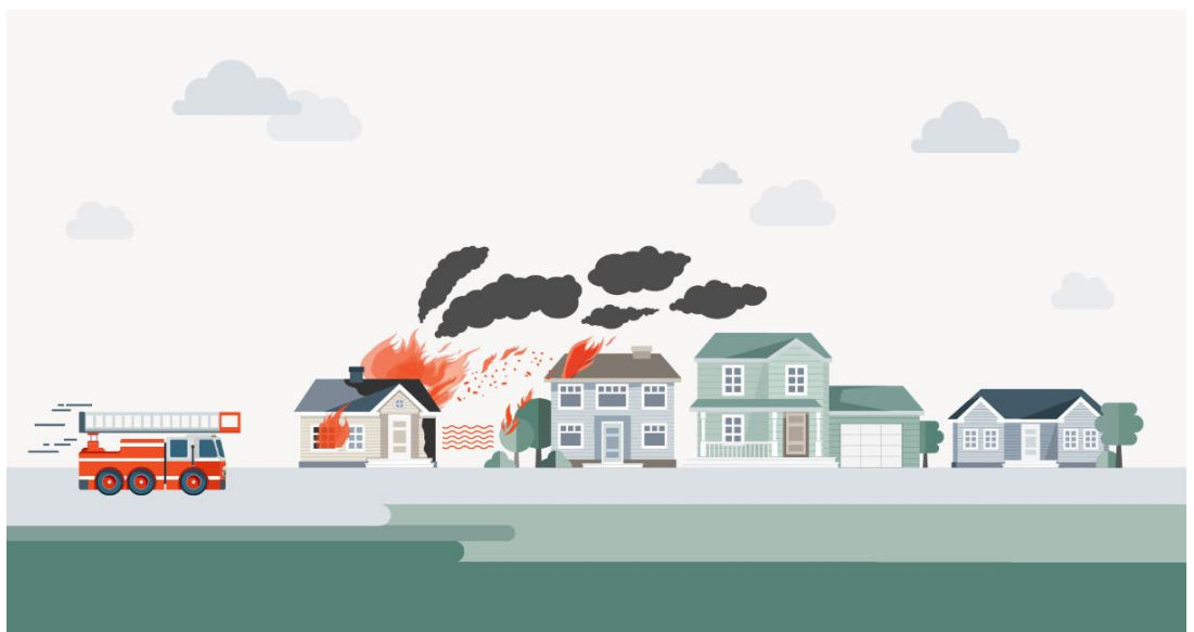
Figur 7: Illustrasjon viser vanlige prinsipper for brannspredning ved bybranner; Stråling, flammekast og flyvebrann.
