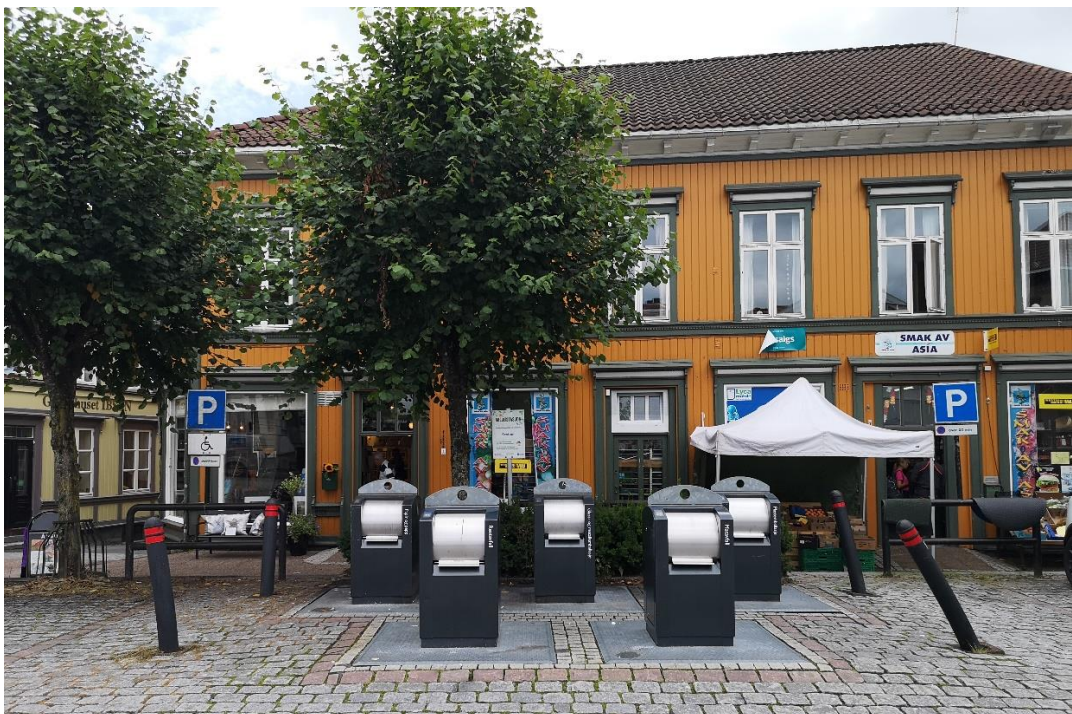
Figur 23: Nedgravd avfallssystem som erstatter titalls plastdunker i Grimstads trehusbebyggelse.
