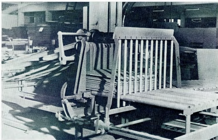
Maskinen stifter både bølgepapp og massivpapp. De ferdige kassene stilles opp og leveres ut i bunter.
