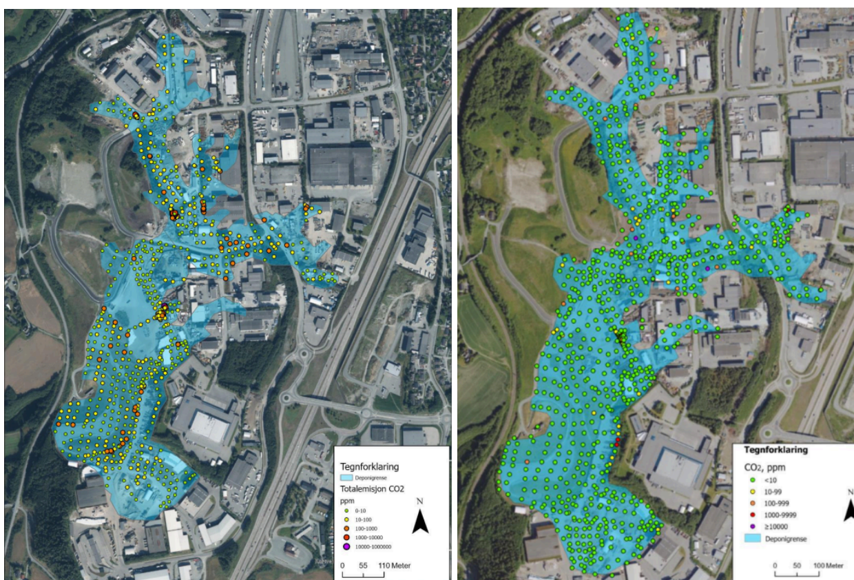
Figur 5.2: Målt overflateemisjon av CO 2 innenfor deponigrensa (blått) i 2023. Skalaen i ppm nede til høyre. Målte verdier av CO 2 er korrigert for bakgrunnskonsentrasjonen i luft. Kilde: COWI, 2024a.
