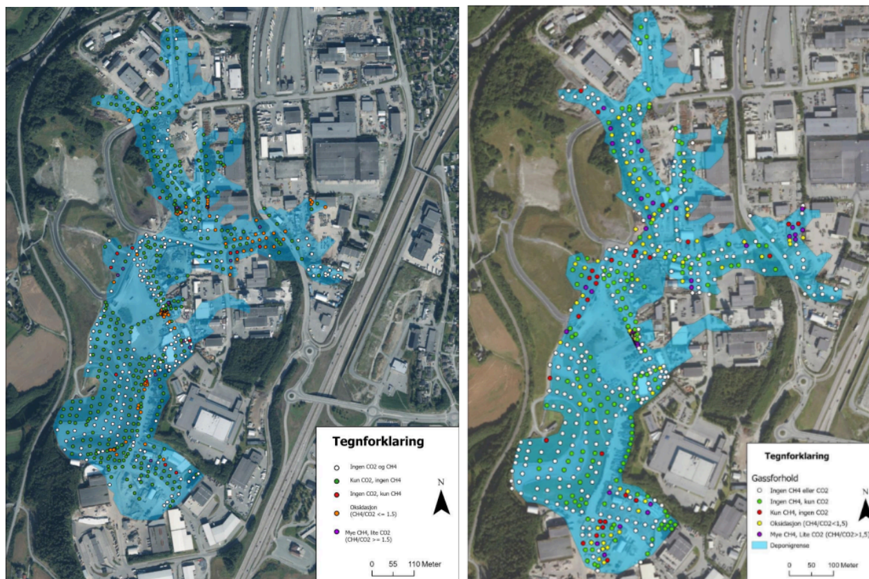
Figur 5.3: Forholdstall (korrelasjon) mellom metan og karbondioksid ved emisjonsmålinger (Cowi, 2024a).
