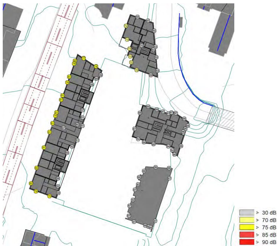
Figur 4 – Innfallende maksimale støynivåer, L_{5AF} . Høyeste fasadenivå er vist, uavhengig av etasje (vedlegg 6).
