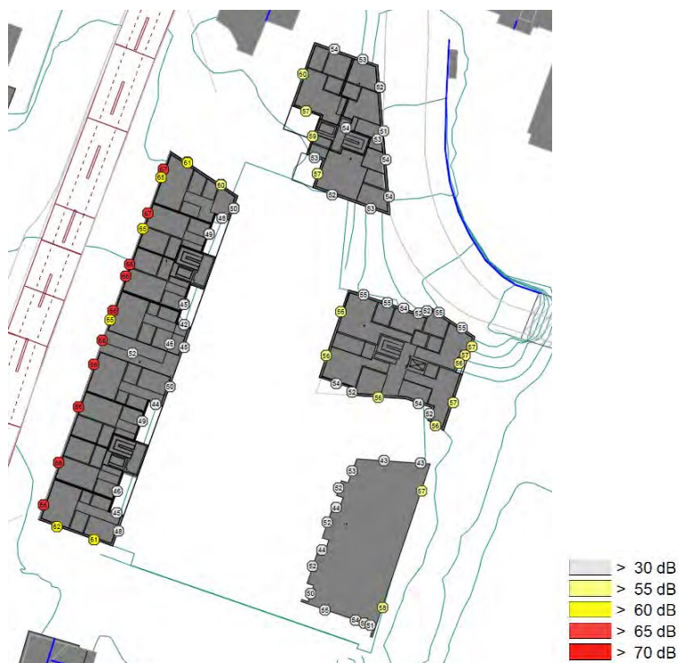
Figur 3 - Innfallende døgnevivalent støynivå, L_{den} , fra veitrafikk. Høyeste fasadenivå er vist, uavhengig av etasje (vedlegg 5).
