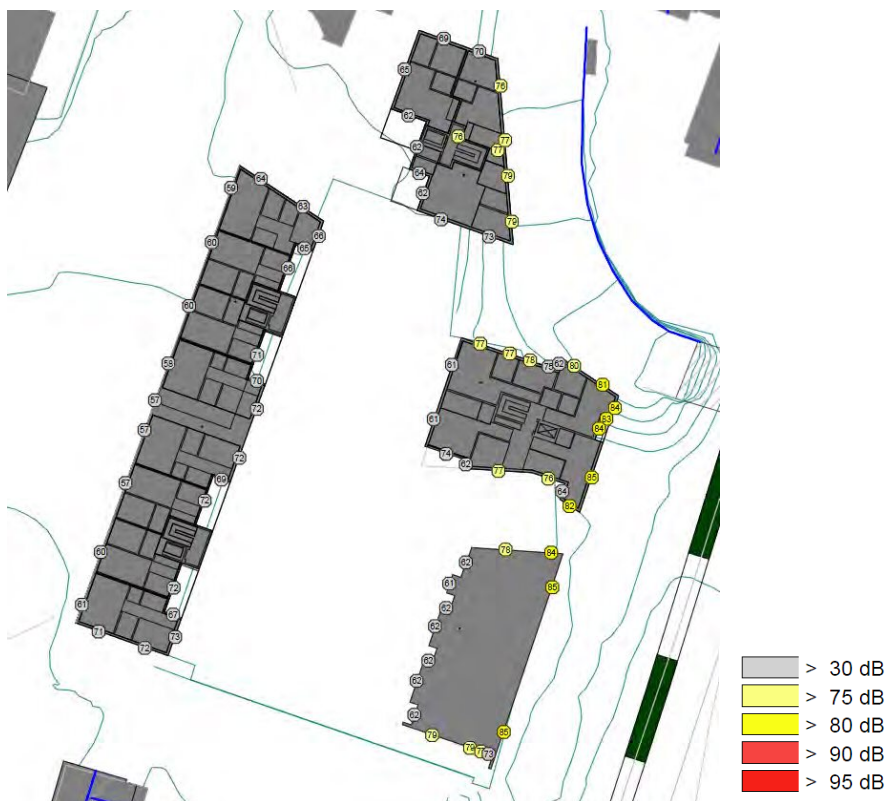
Figur 12 - Innfallende maksimale støynivåer, L_{5AF} . Høyeste fasadenivå er vist, uavhengig av etasje (vedlegg 14).
