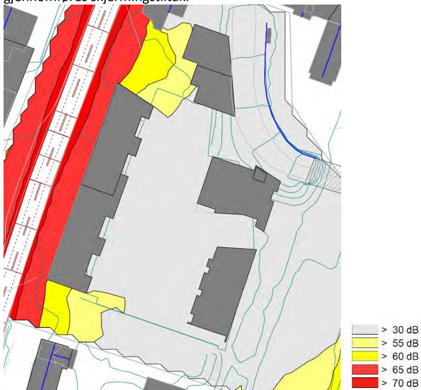
Figur 5 - Støykart, L_{den} , fra veitrafikk ved uteoppholdsareal. Beregningshøyde: 1,5 meter over terreng (vedlegg 4).
