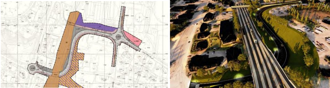
Figur 8: Johan Tillers veg i kulvert under Dovrebanen (Miljøpakken, 2017)
