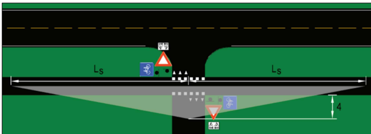
Figur 23: Sikt mellom sykkelveg (med fortau) og veg der sykkelvegen (med fortau) er forkjørsregulert (Norwegian Public Roads Administration, 2022, s. 96).
