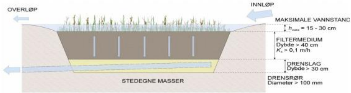
Figur 1. Regnbed på leirjord, med utskiftet filtermedium og drenering.
