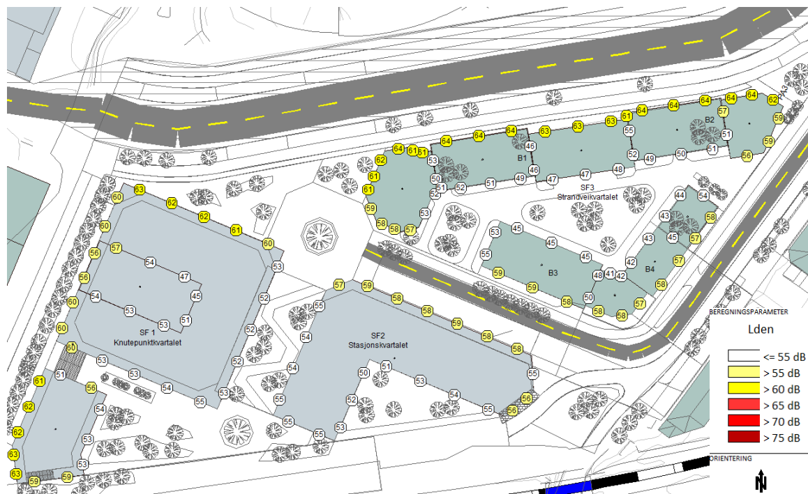
Figur 8 - Beregnet ekvivalent samlet støynivå, L_{den} , fra veitrafikk og jernbane iht. metode i T-1442/2021. Figuren viser støynivå på fasade uavhengig av etasje. Utklipp fra vedlegg X007.
