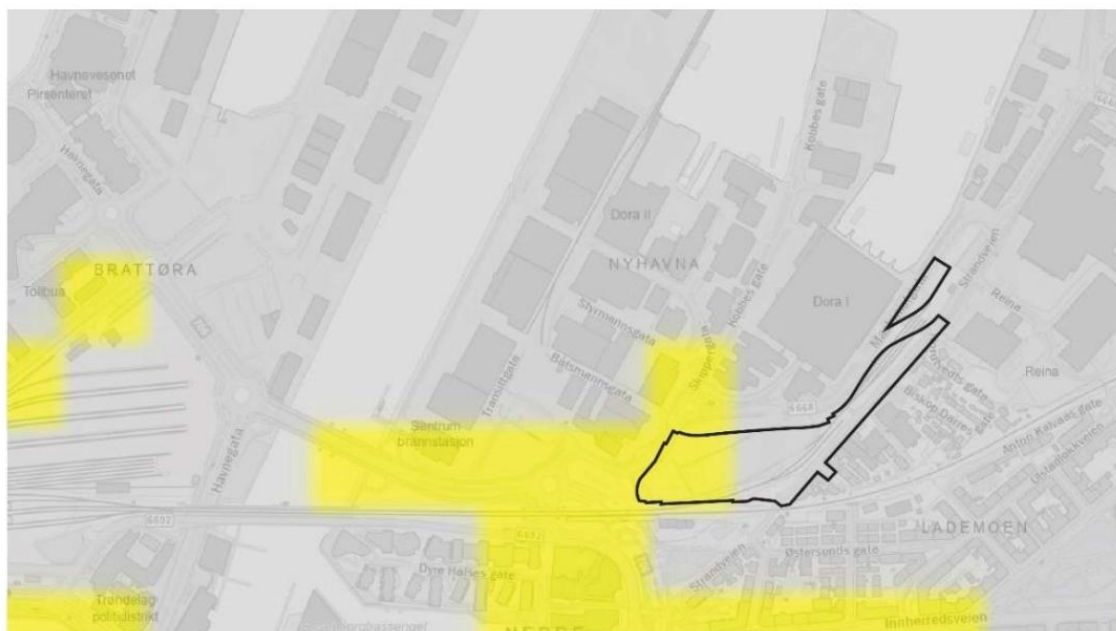
Figur 4. Luftsonekart som viser utbredelsen av Retningslinje T-1520 rød og gul sone ved planområdet – markert med svart omriss – beregnet med meteorologi for årene 2019-23. Tatt fra lokalklimaanalyse for Maskinistgata 2 (Asplan Viak, 2025), modifisert fra Luftkvalitet i Norge (Miljødirektoratet, 2025a).
