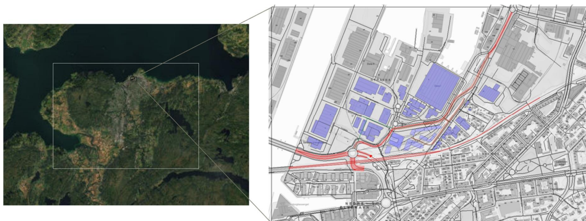
Figur 6. Oversikt over modellområdet for Maskinistgata 2 brukt i spredningsmodelleringen. Beregningsområdet for GRAMM er markert med rektangel på ortofotoet til venstre, og for GRAL til høyre. GRAL-illustrasjonen viser bygninger (lilla), veg-utslippskilder (røde) og portalkilde (røde piler) i modellen markert.
