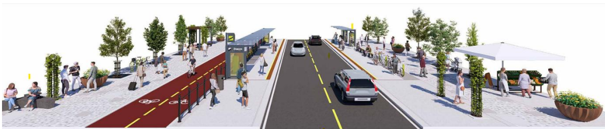
Illustrasjonen viser prinsippsnittet for Maskinistgata med holdeplasser.
