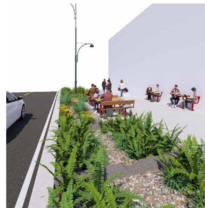
Regnbet opparbeides med terskler i granitt.
