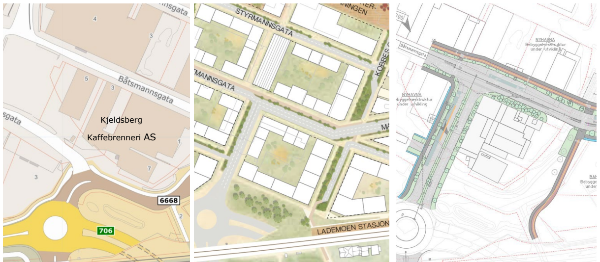
Figur 4-2: Til venstre dagens situasjon for Skippergata og Båtsmannsgata. I midten vises løsningen slik det er presentert i Kvalitetsprogrammet for Nyhavna, mens det til høyre er vist valgt løsning for reguleringsplanen.
