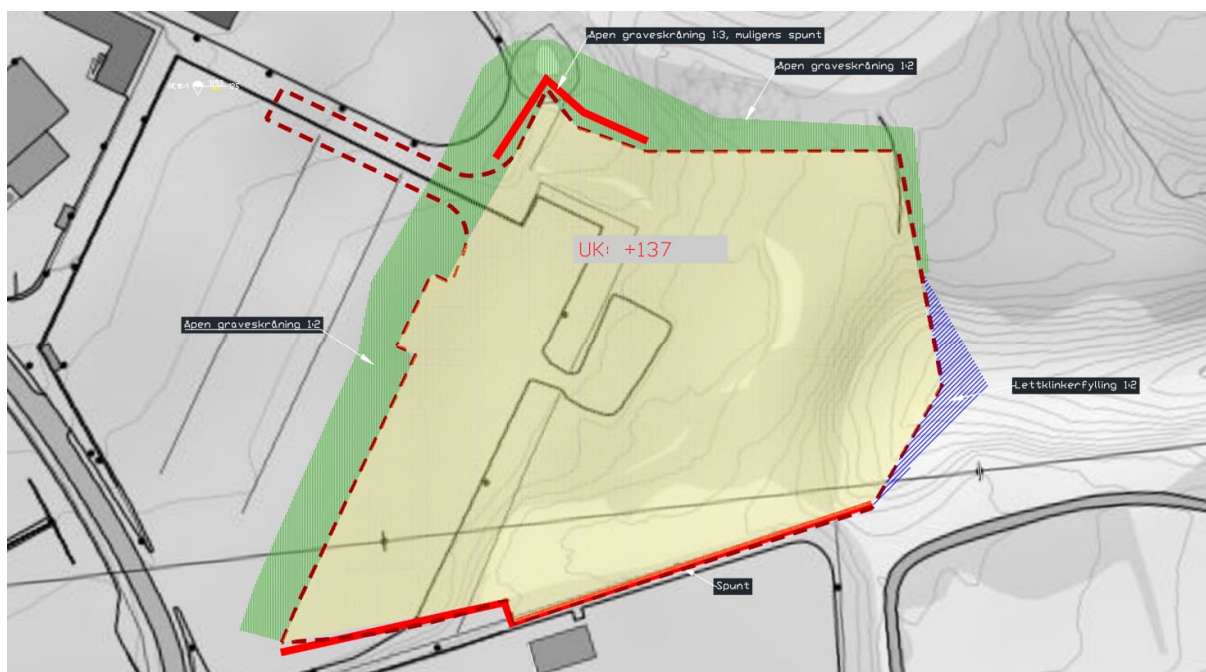
Figur 8.1: Illustrasjon på forslag på utgravningsløsninger og oppfylling med fullt utnyttet tomt, og illustrert plassering på spunt (rød linje).
