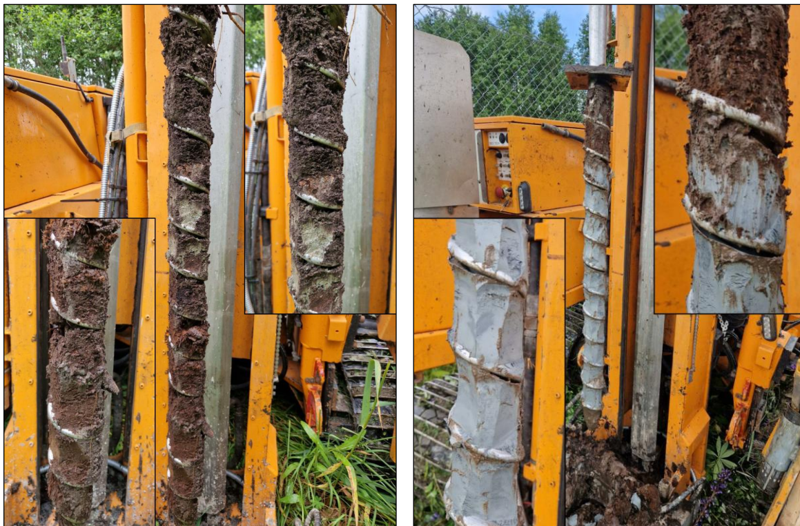
Figur 5-6. Til venstre: Skovlprøve fra punkt M19-1, dybde 0 – 1 meter. Til høyre: overgang til mulig stedeegne masser. Skovlprøve fra punkt M22-6, dybde 8 – 9 meter, Sandmoen 3. Foto: Rambøll, 2025.
