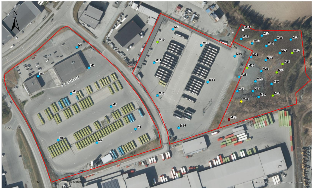
Figur 5-8. Utsnitt fra tegning M102. Kartet viser en oversikt over forurensningssituasjonen på tiltaksområdet, hvor hvert prøvepunkt er angitt med høyeste påviste tilstandsklasse iht. Miljødirektoratets veileder for forurenset grunn [8] og Trondheim kommune sitt faktaark 63 [9]. Kilde: Geodata AS, Kartverket, Geovekst og kommunene.
