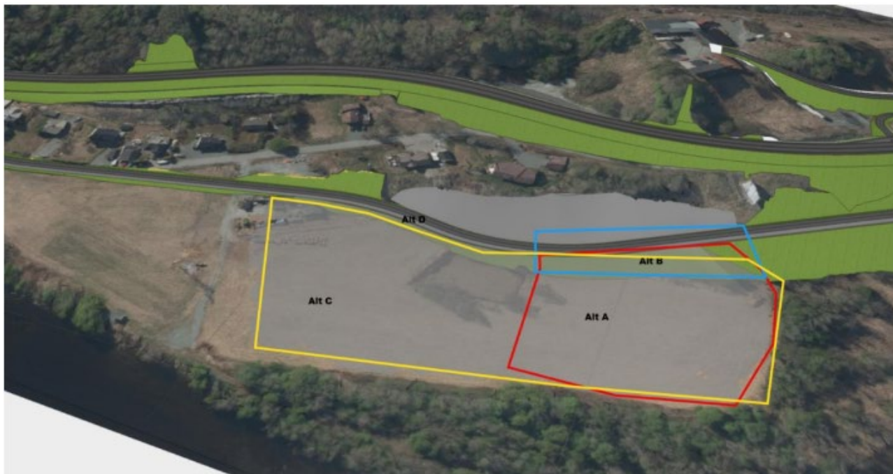
Figur 36: Alternativer for utforming av motfylling. Kilde:Multiconsult
