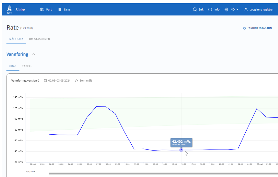
Figur 2-1. Vannføring i Nidelva registrert ved målestasjon VM 123,230 Rate den 2. mai 2024, kilde: https://sildre.nve.no/station/123.20.0 .
