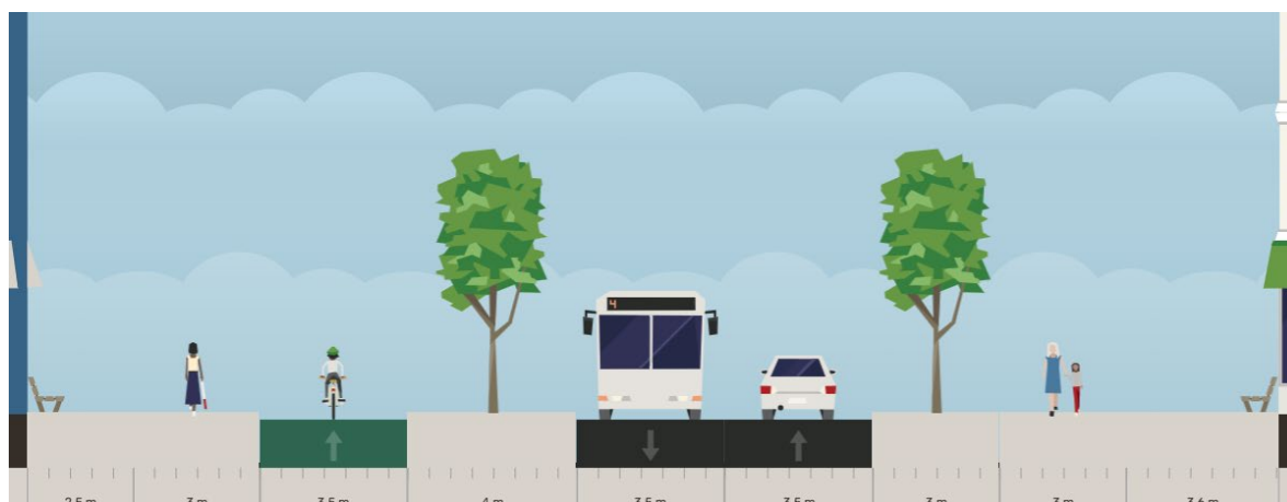
Figur 9-1: Endelig snitt for Sluppenvegen øst. Tverrprofil på 29,6 m (økt fra 27 m i KDP).
