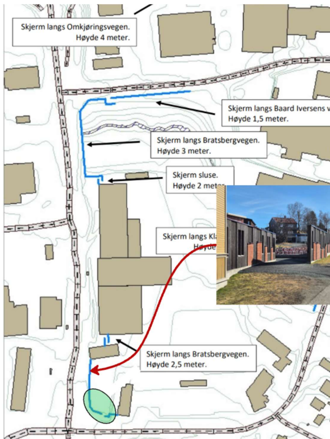
Figur 20: Forslag til støyskjermer Nidarvoll skole . Bilde og rød pil viser hvor støyskjerm og sluse som er bygget.
