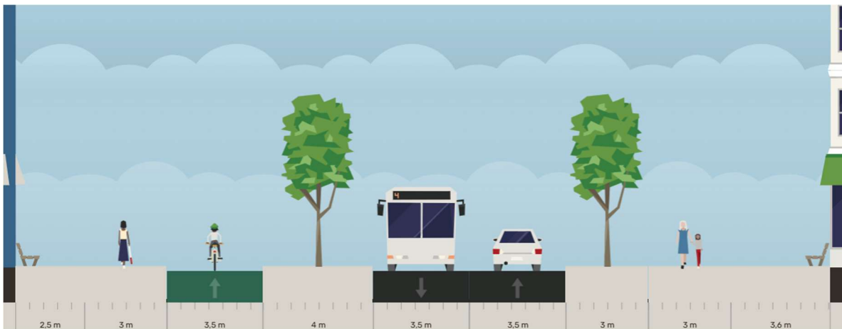
Figur 11: Endelig snitt for Sluppenvegen. Tverrprofil på 29,6 m. Laget i streetmix.net
