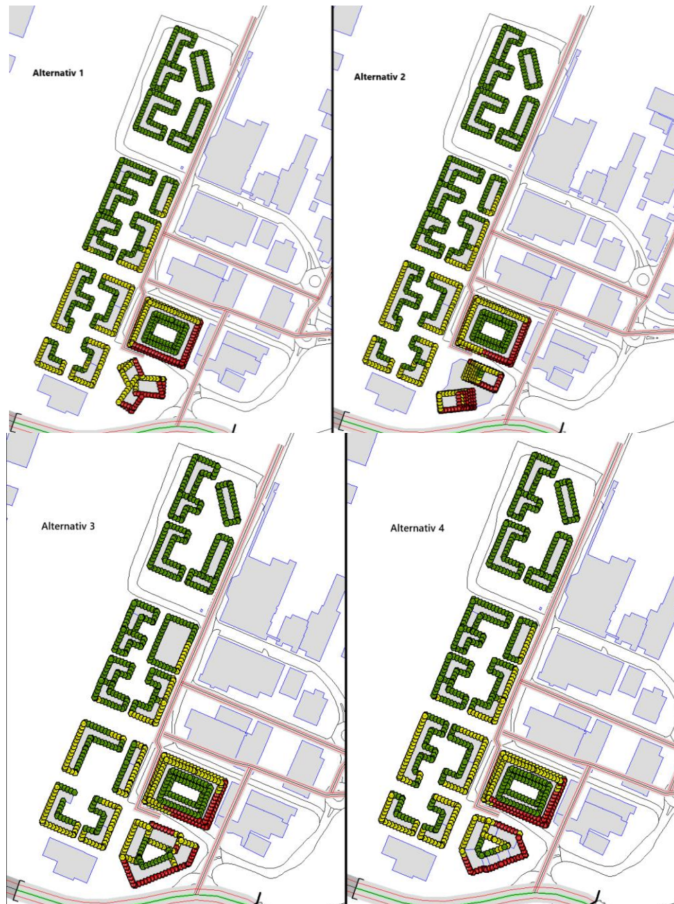
Figur 18 - Sumstøj beregnet på facaden under transformationsfasen.
