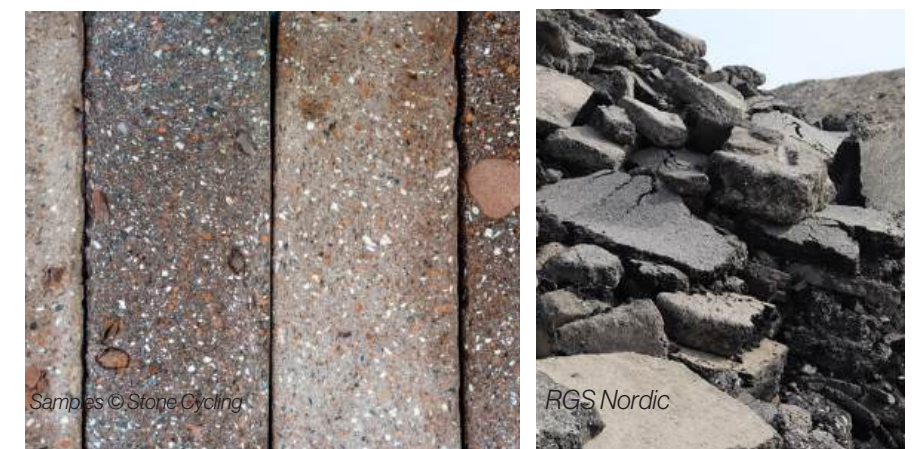
Eksempler på knusning til fraktioner genanvendt i nye materialer
