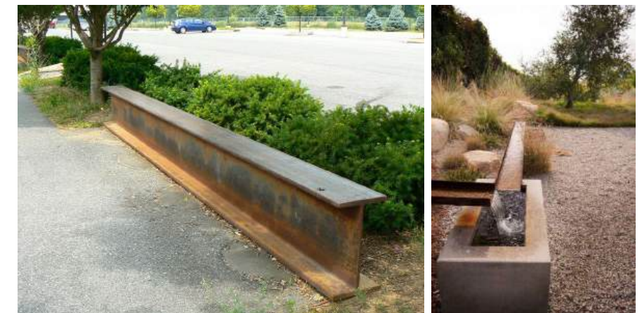
Eksempel på stålkonstruktioner genanvendt i byrumsdesign
