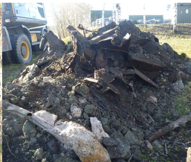
Figur 11 Bilde av prøvesjakt HG1B. Oppgravde masser med mye avfall.
