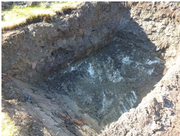
Figur 12 Bilde av prøvesjakt HG7. Matjord og fyllmasser med noe teglrester, over fjell på 1,4 m.
