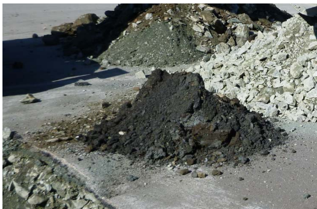
Figur 14 Bilde av prøvesjakt HG10. Oppgravde masser med mørk farge.
