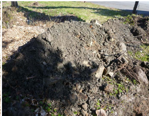
Figur 13 Bilde av prøvesjakt HG8. Oppgravde avfallsholdige fyllmasser.
