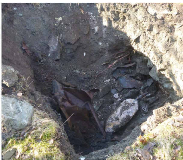
Figur 10 Bilde av prøvesjakt HG1B. Masser med mye avfall.
