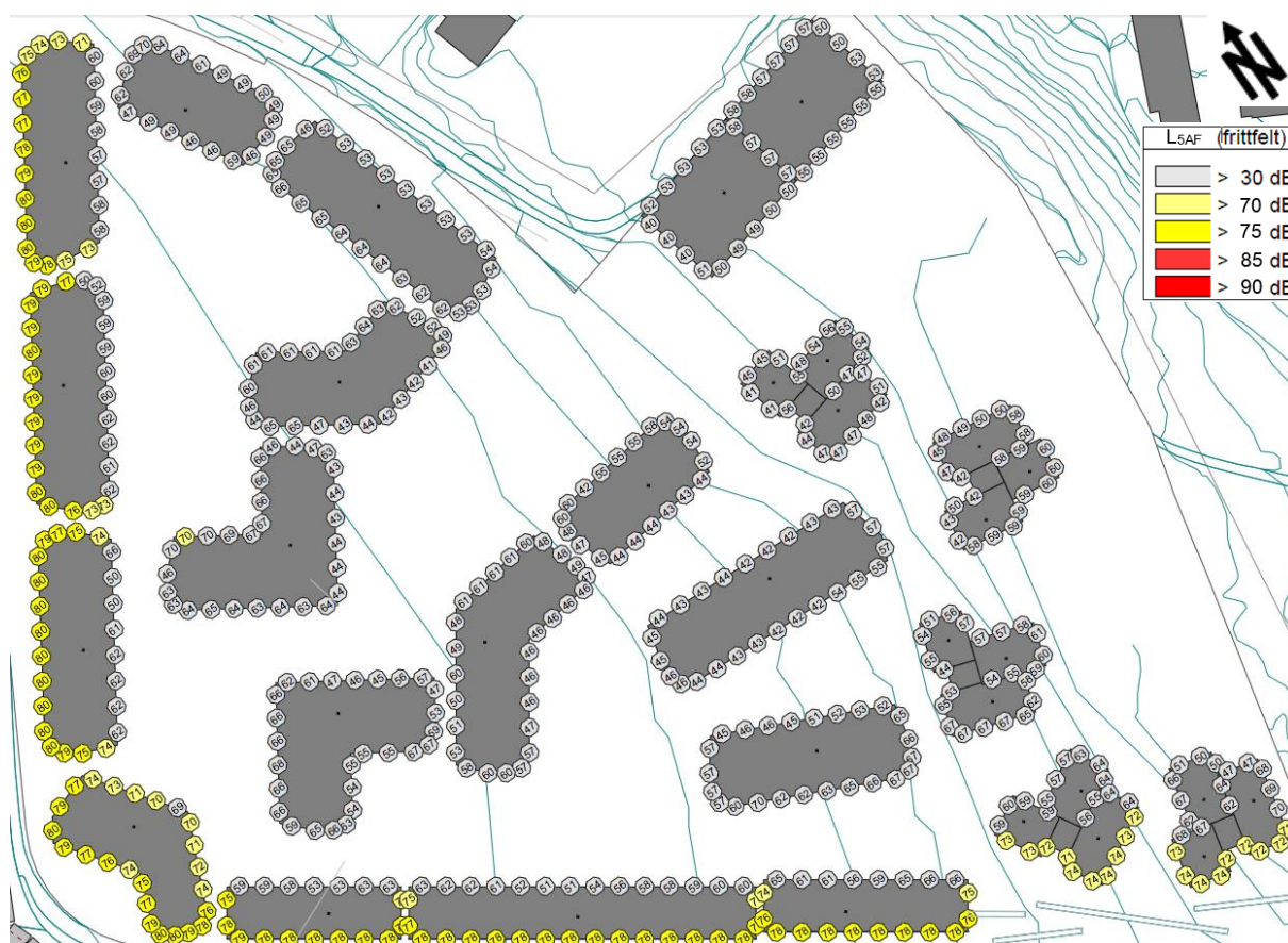
Figur 9 - Beregnet A-veid maksimalt lydnivå, L_{5AF} . Sirkelene viser det høyeste støynivå, L_{5AF} , i fasaden av alle etasjer. Kravet til maksimalnivå gjelder kun utenfor vindu til soverom på nattestid.
