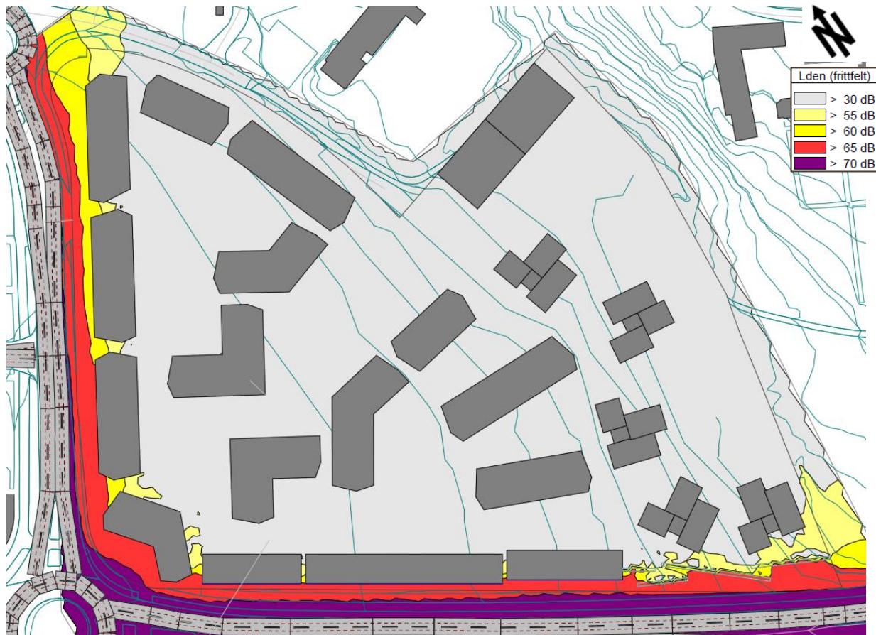
Figur 6 - Beregnet støy, L_{den} , på uteområdet med planlagte skjermer i sør (beregnet i høyde 1,5 m over terreng).
