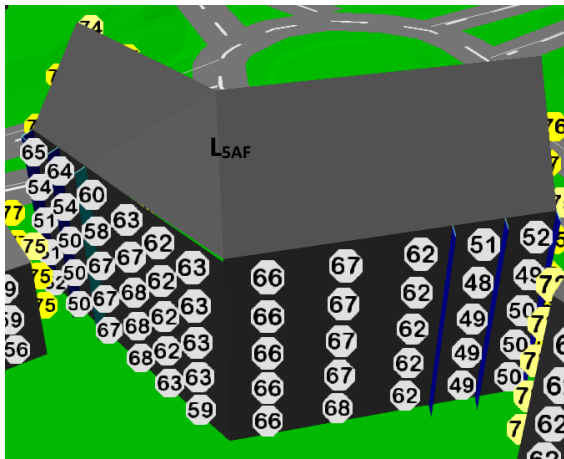
Figur 12 - Beregnet A-veid maksimalt lydnivå, L_{5AF} , på fasade mot øst i bygg mot rundkjøringen i vest, med skjermingstiltak i form av tette sidefelter på balkonger.
