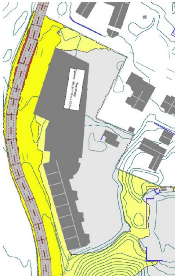
Støyforhold uten skjerming, 1,5 m over terreng
