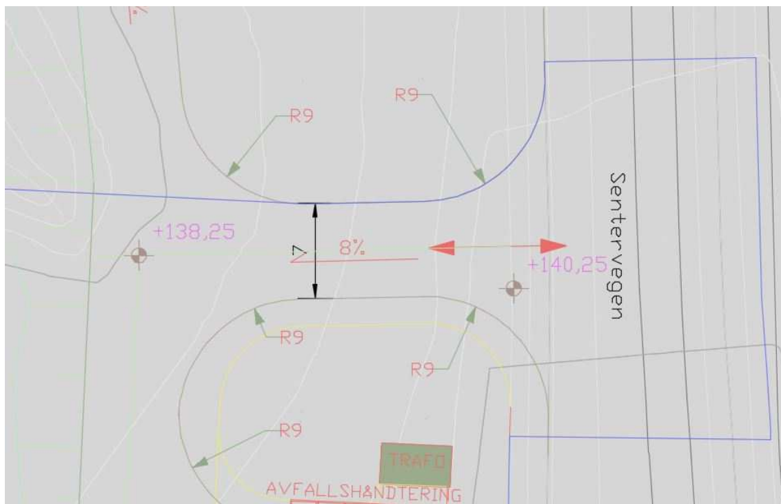
Figur 3: Planlagt geometri i kryss (Grunnlag fra Rett Hjem Arkitekter, 17.03.2017)
