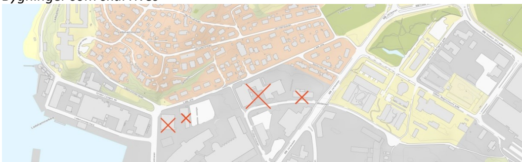
Figur 11: Eksisterende bygning som skal rives er vist med kryss. I tillegg må del av bygning i Ladebekken 6 (gnr 415/172) også rives fordi den går ut i den nye traseen til vegen Ladebekken.
