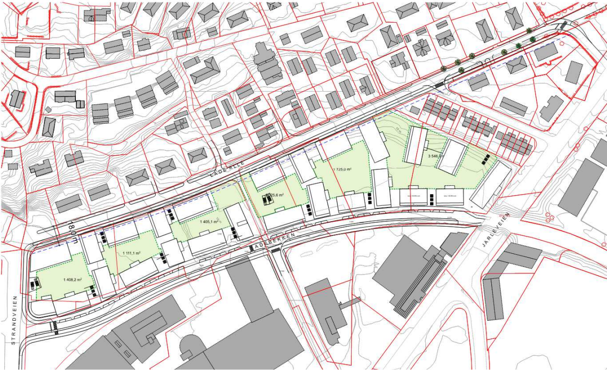
Figur 5-2 Stiplet linje viser vegkant ved vegbredde på 18 m
