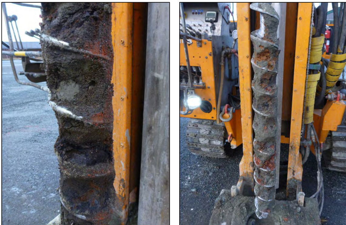
Figur 10 Prøveserier fra prøvepunkt M20 (til venstre) og M23 (til høyre) med fyllmasser av sand og grus, enkelte mørke lag og rester av tegl.
