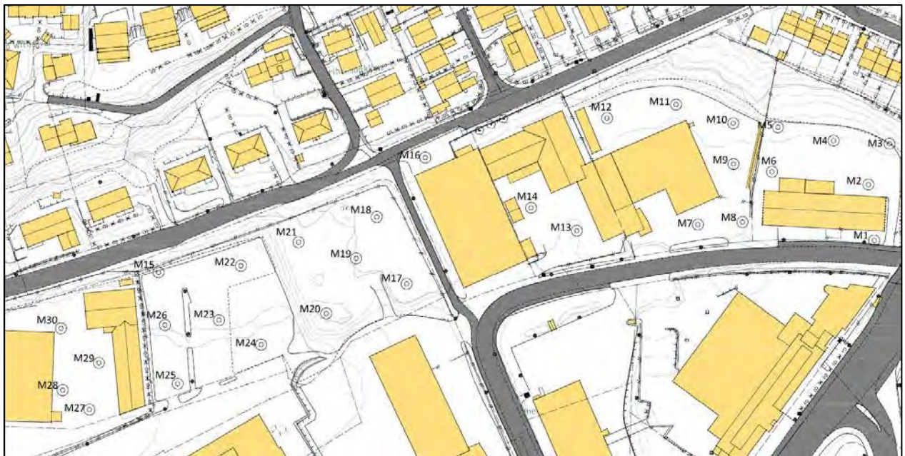
Figur 9 Kart som viser plassering av prøvepunkter for uttak av jordprøver.
