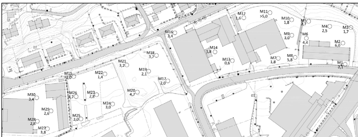
Figur 12. Figur som viser tolket mektighet av fyllmasselaget i de utførte prøvepunktene. Tolkningene er kun gjort for å illustrere mektigheten av fyllmasse som kan være forurenset, og kan f.eks ikke legges til grunn for geoteknisk eller byggeteknisk prosjektering.
