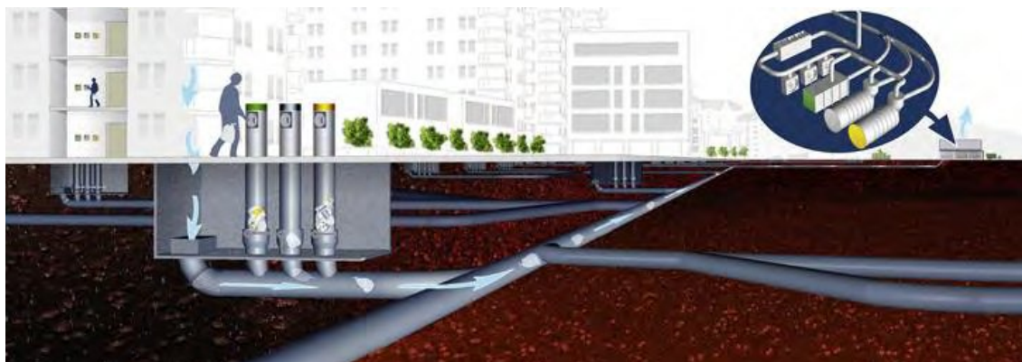
Figur 5 Skisse over stasjonært sugesystem. Kilde: Stationära vakuumsystem. Envac AB. http://www.envac.se/web/Stationara_vakuumsystem.aspx
