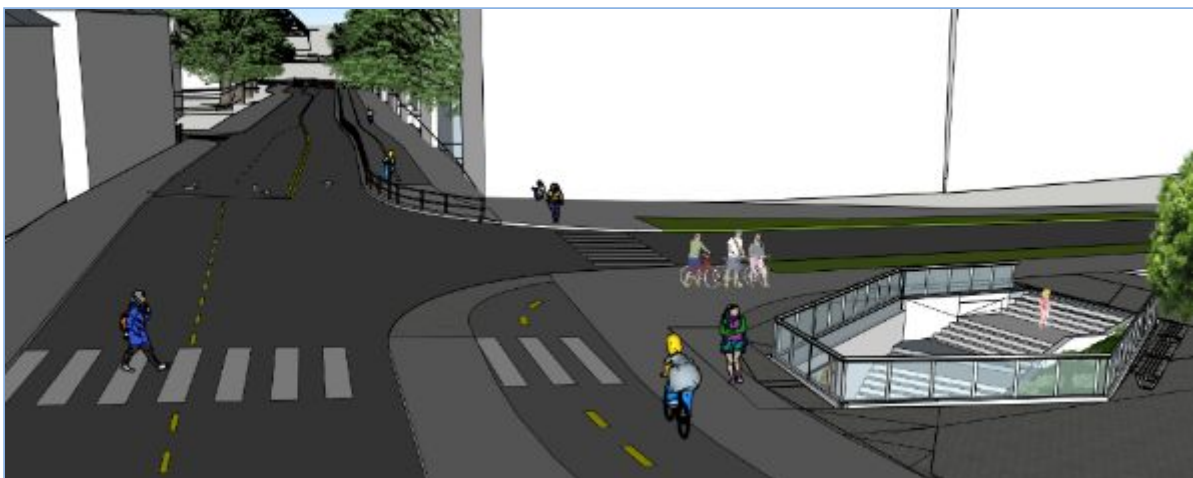
Figur 21: Det bør vurderes sikringsgjerde langs deler av Innherredsveien
