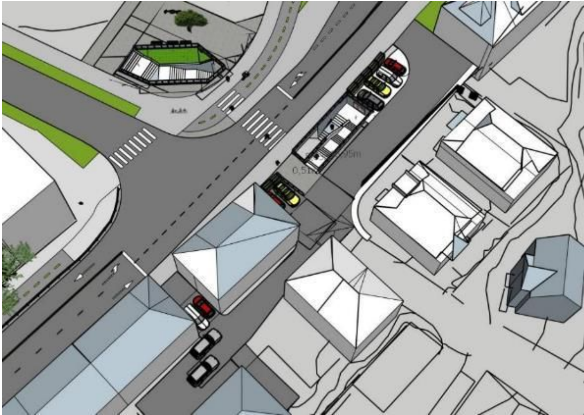
Figur 11: Samling av avkjørsler og endring av parkering og utforming av undergang
