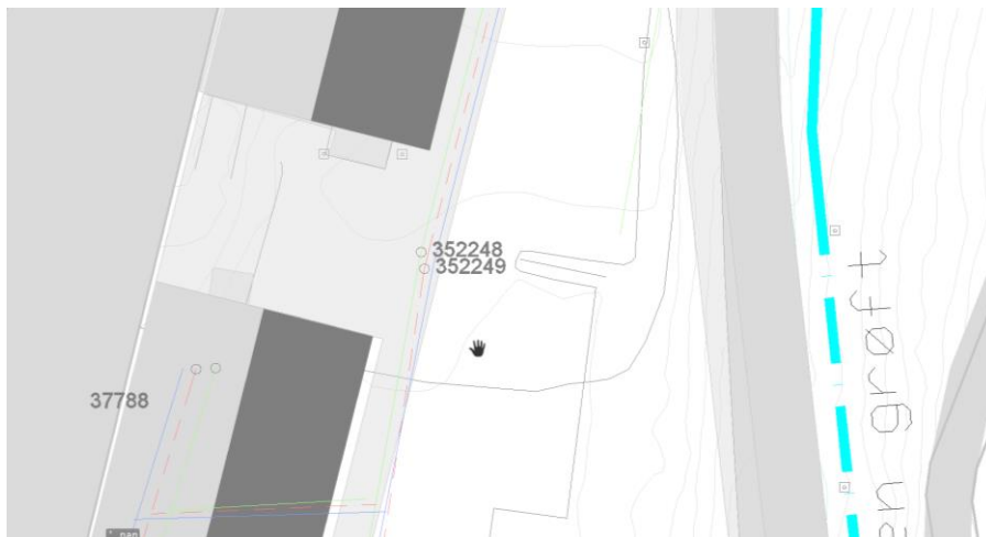
Figur 6: Vann og avløp fra langrennsarenabygg kobles til kum 352248-49 – nordøst for nytt bygg.
