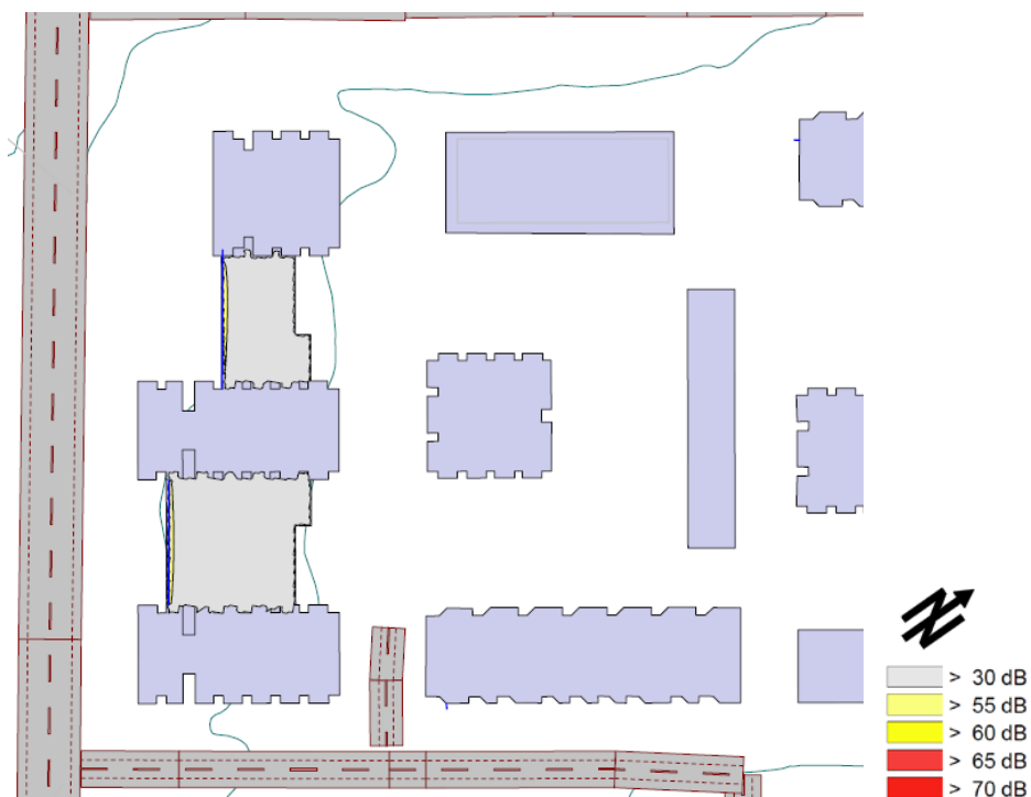
Figur 6 - Støykart for uteoppholdsareal ved takterrasse over næringsarealer i bygg C. Tett rekkverk med høyde 1,5 meter ut mot Haakon VII's gate. Beregningshøyde: 1,5 meter over dekke (vedlegg 6).
