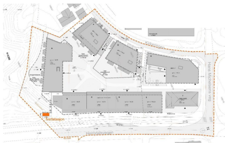
Figur 12 – plassering av fremtidig nettstasjon
