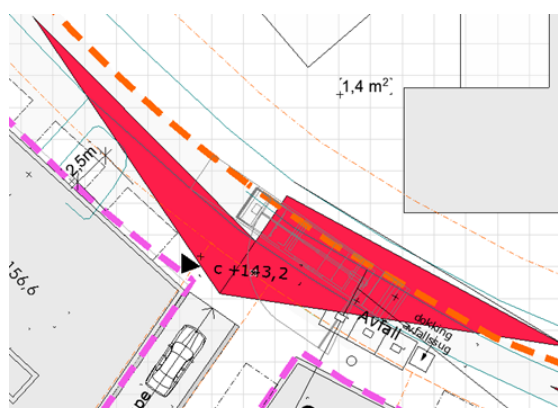
Figur 1 – sikt mot renovasjon avkjørsel Kirkeringen
