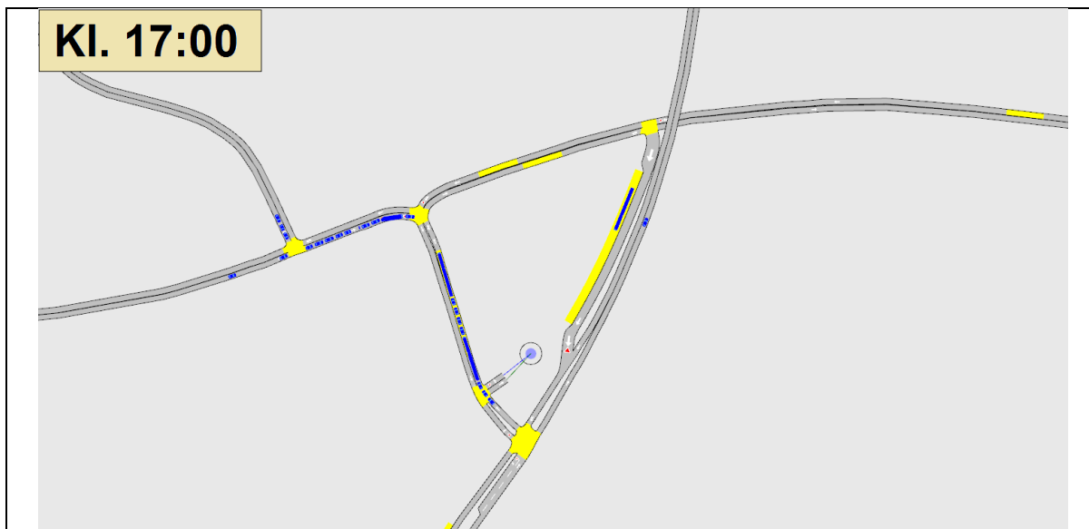
Figur 18: Skjermdump av trafikksituasjon på halvtimesnivå, ettermiddag 2019 + 50 % med kantstopp
